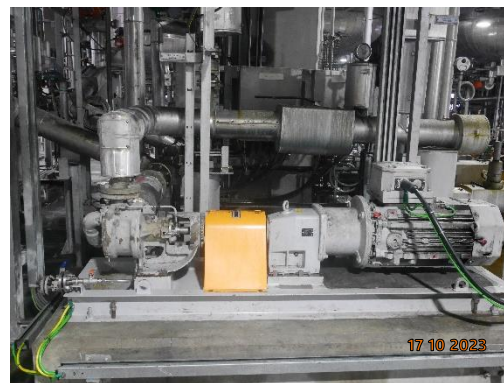
รูปที่ 7 ป้อนระบบป้องกันการรั่วไหลสองชั้น (Double Mechanical Seal)
